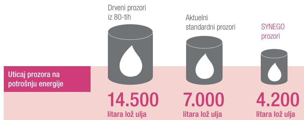
Račun: Površina prozora od  $25 m^2$ , potrošnja lož ulja za 25 godina; drveni prozori sa  $U_w = 2,79 \text{ W/m}^2\text{K}$ ; standardni prozori sa  $U_w = 1,36 \text{ W/m}^2\text{K}$ ; SYNEGO prozori sa  $U_w = 0,66 \text{ W/m}^2\text{K}$
